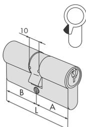
• Двухсторонний муфтовый цилиндр (позволяет открывать и закрывать замок при ключе, вставленном с другой стороны)
