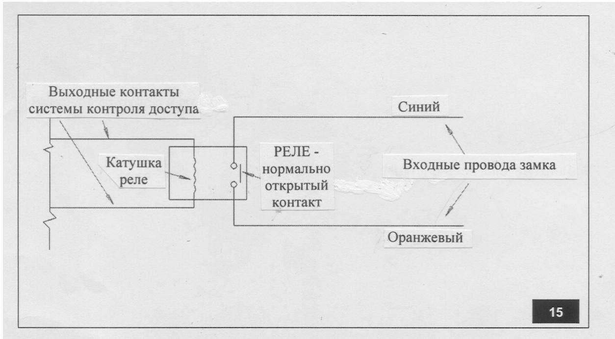
В том случае, если уже предусмотрен один из двух способов прямого управления открыванием, описанных выше, можно подключить эту функцию, соединив параллельно с домофоном или контролем доступа выключатель, который в положении ON замыкает провода и в положении OFF размыкает контур.
