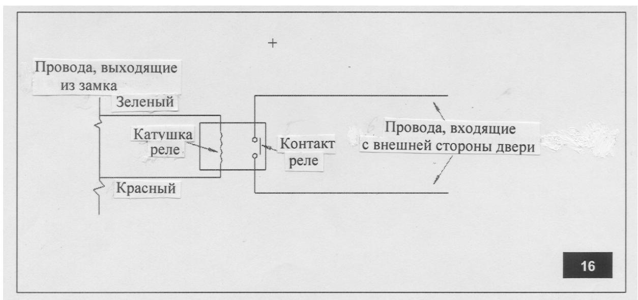
Провода, выходящие из замка (красный и зеленый), должны быть подсоединенены к катушке реле, тогда как к контакту реле следует подсоединять провода, входящие в систему, с которой необходимо установить соединение.
